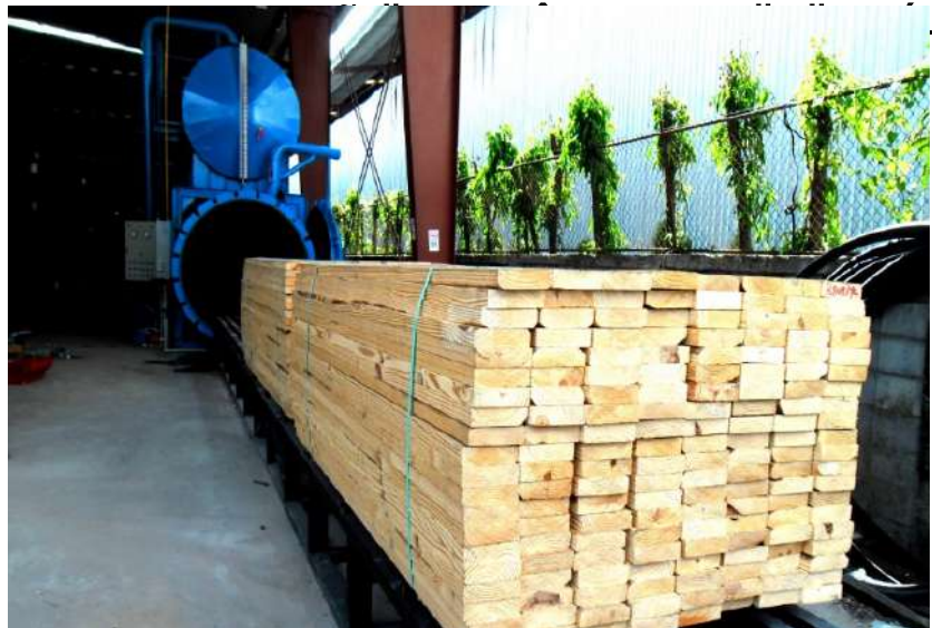
Micronized Copper Azole Green Guard เหมาะสำหรับไม้ที่อัดได้ง่ายการันตี ปลวก มอด รา ทำลายเนื้อไม้ 20 ปี ภายนอก อัดได้สูงสุดถึง H5 ใช้น้ำจืดได้ Green guard
