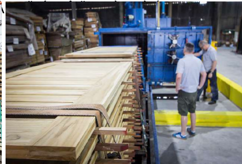
Double Vacuum Anti termite treatment อัดได้สูงสุด H3.2 ใช้งานภายนอกไม้ สัมผัสดิน ใช้งานได้เกือบทุกชนิดในโลก ใช้งานได้ทุกผลิตภัณฑ์ไม้ Chale'T
