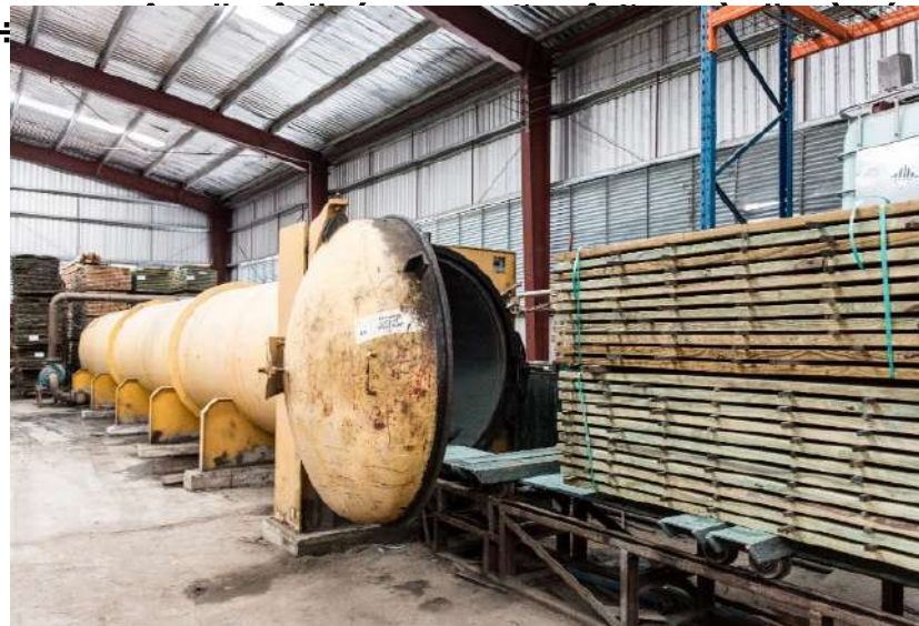
Color preservative Impregnation เครื่องอัดน้ำยาบวกล + เม็ดสีที่เปลี่ยนสีเนื้อไม้ ได้ อัดได้สูงสุดถึง H5 ใช้น้ำจืดได้ Green guard
